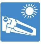
輕輕圖上蓋板,避免氣泡 產生,使溶液遍佈棱鏡表 面,對準光源或明亮處, 眼晴觀察目鏡視場。
