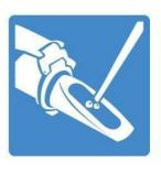
打開蓋板 · 用軟布仔細擦 淨檢測棱鏡 · 取待測溶液 數滴 · 置於棱測鏡上。
