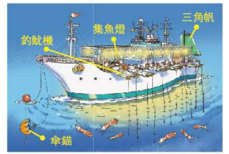
先用船上的集魚燈吸引魷魚前來，再從船邊的釣魷機垂下釣線，將魷魚釣起。
