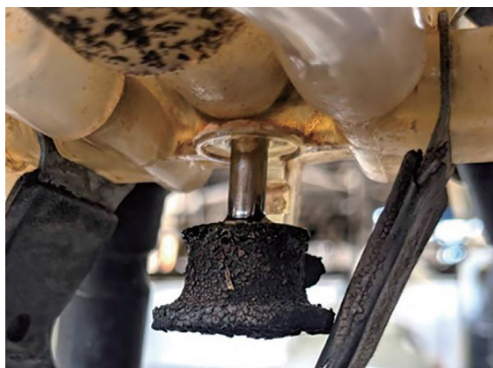
▲圖7、老化鬆脫的阻斷閥。(圖片來源：統一公司)
